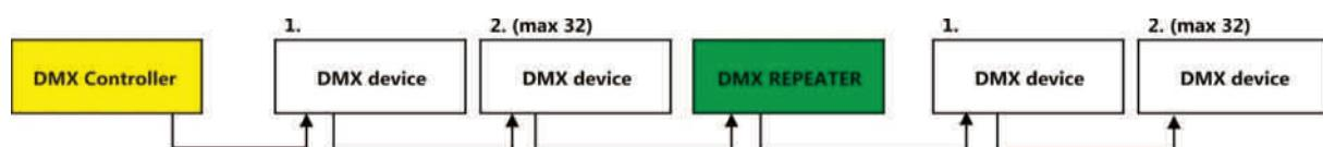
Die DMX Norm erlaubt den Anschluss von bis zu 32 Einheiten in einer Leitung.
