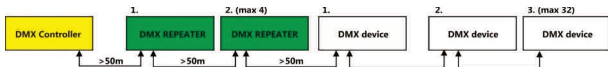
**Wegen der bidirektionalen Kommunikation ist es nicht möglich, ein DMX Gerät zwischen Controller und Repeater anzuschließen.** Bei sehr langen Kabelstrecken können in einem System nacheinander mehrere Repeater angeschlossen werden (maximal 4).
